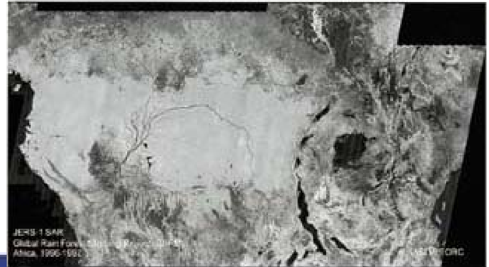
画像3 JERS-1のSARを用いたアフリカ中央部のモザイク画像。森林からのレーダ反射強度は、水面や伐採地や裸地より明るく見える。
